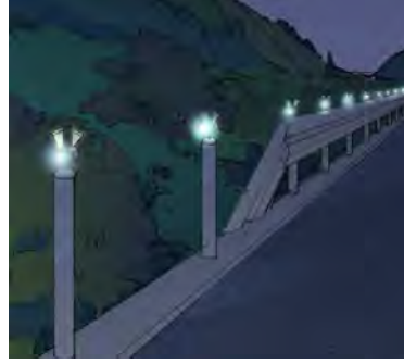
高速道路を通過する車の風圧や振動で発電し、LEDライトを点灯する。
